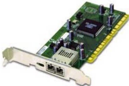
Placa de Rede com Conectores para Fibra Ótica.
